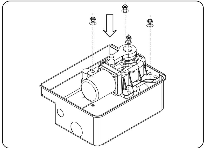
Insertar la parte esférica en el perno ubicado en la caja y acoplar la palanca de anclaje cancela (L1)
