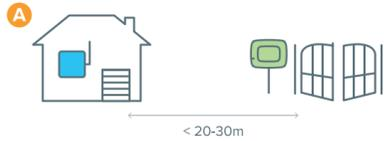
A) QK-LIB50 positionné près du portail et QK-LIBWIFI positionné dans la maison sur la fenêtre la plus proche du portail. Avec ce positionnement, vous pouvez ouvrir la porte à la fois en utilisant le Bluetooth et en utilisant le Wi-Fi.
