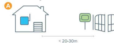
A) QK-LIB50 platziert in der Nähe des Turms und QK-LIBWIFI platziert im Haus, am Fenster, das dem Tor am nächsten liegt. Diese Lösung ermöglicht Ihnen, das Tor sowohl mit Bluetooth als auch mit WLAN zu öffnen.
