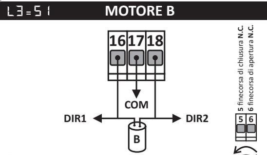
5 finecorsa di chiusura N.C.
