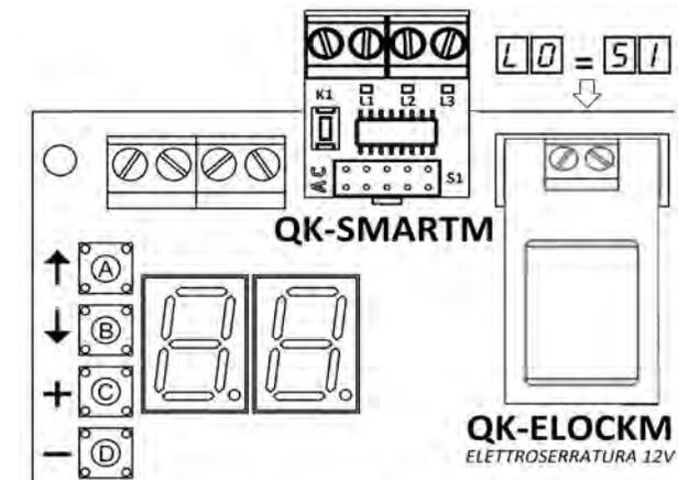
El parámetro **E1** habilita (**SI**) o deshabilita (**no**) el test de las fotocélulas. Le impostazioni (4.A) e (4.C) requieren **E1** configurado en **no**.
