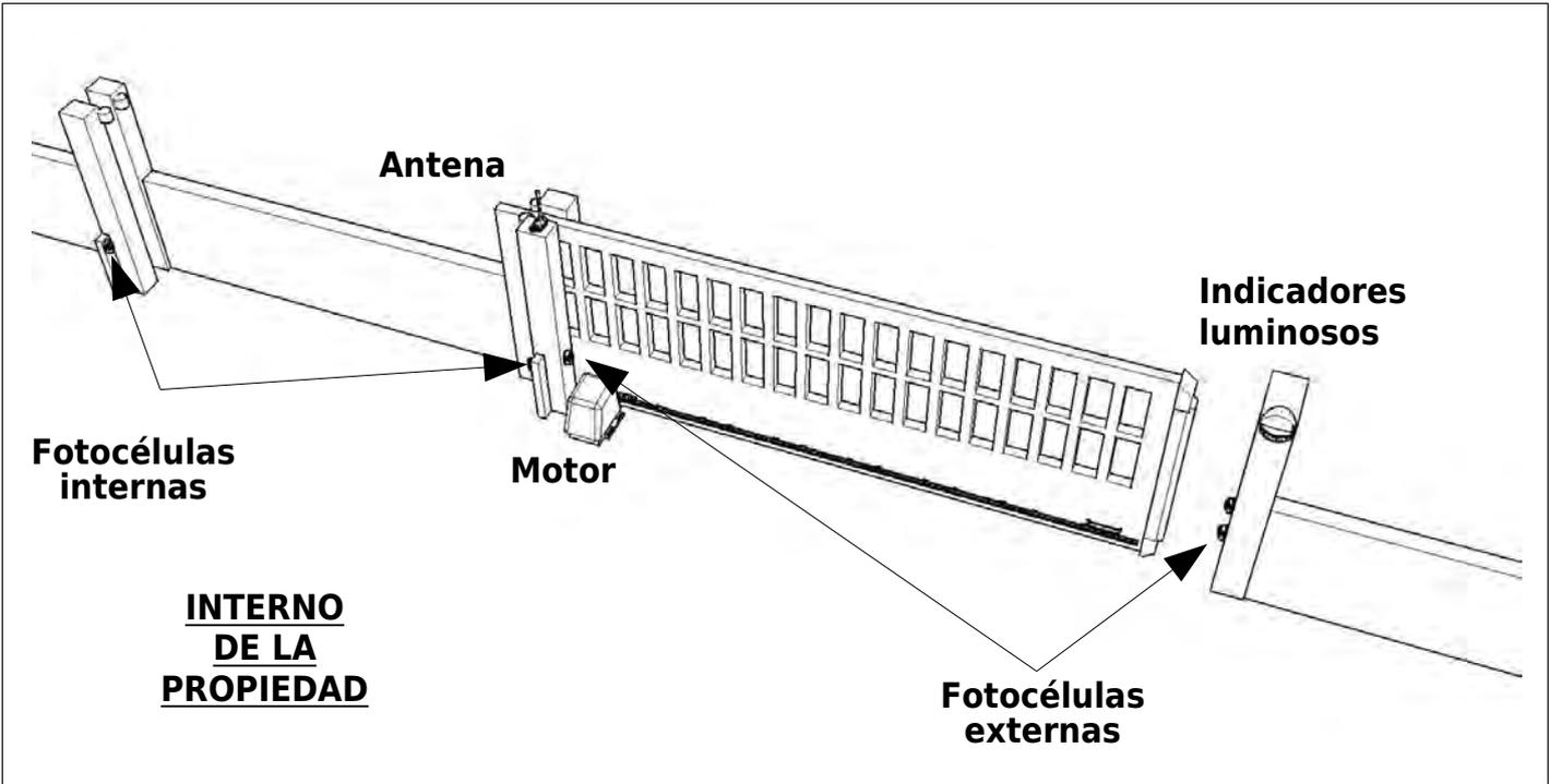
**INSTALACIÓN DEL MÓDULO DE RADIO**
